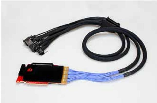
P67SA16S – x16 PCI Express 插槽内插器探头。(另外还提供了 x8, x4, x1 插槽内插器探头)
